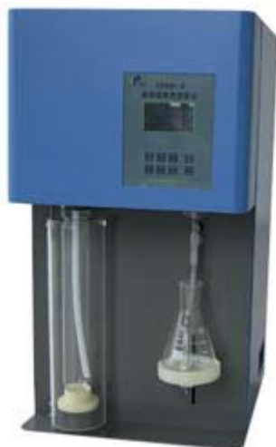
Εικόνα 7.2: Συσκευή απόσταξης που χρησιμοποιήθηκε στη δοκιμή Kjeldahd.
