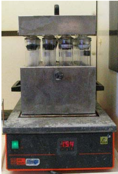
Εικόνα 7.1 :Συσκευή Καύσης που χρησιμοποιήθηκε στη δοκιμή Kjeldahl
