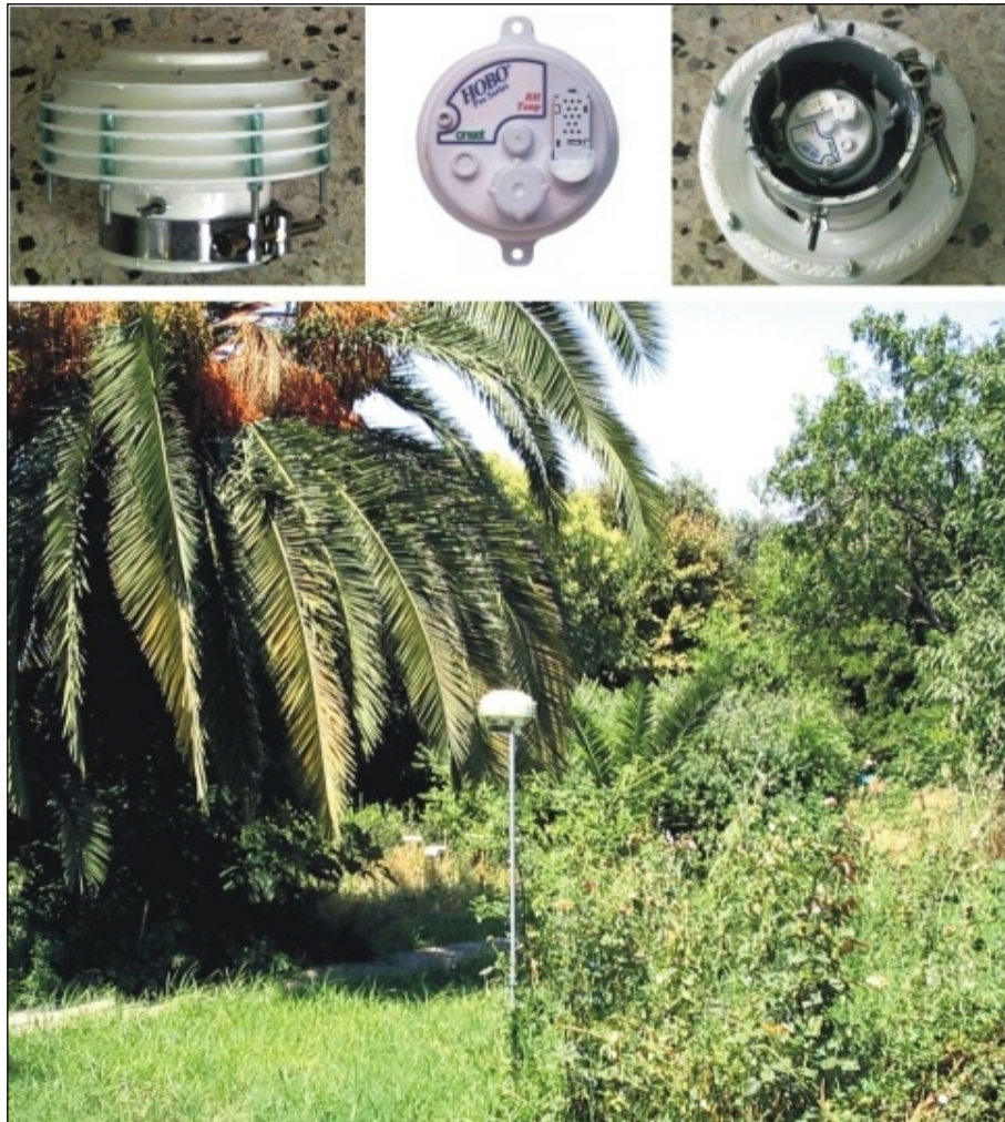
Εικόνα 25. Το όργανο τύπου Hobo, το προστατευτικό του σε φάση κατασκευής και ο τρόπος τοποθέτησης στο πεδίο μετρήσεων (περίπτωση p4).
