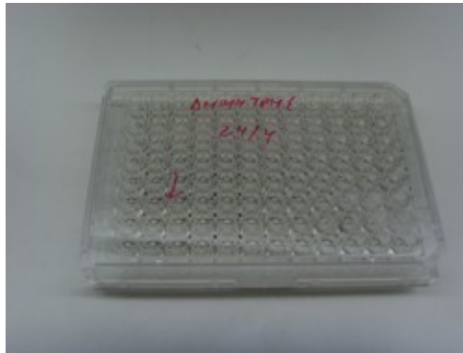
Σχήμα 2.2 Παρασκευή κυτταρικών βιοαισθητήρων BERA 5 ης γενιάς σε πλακίδιο τύπου ELISA
