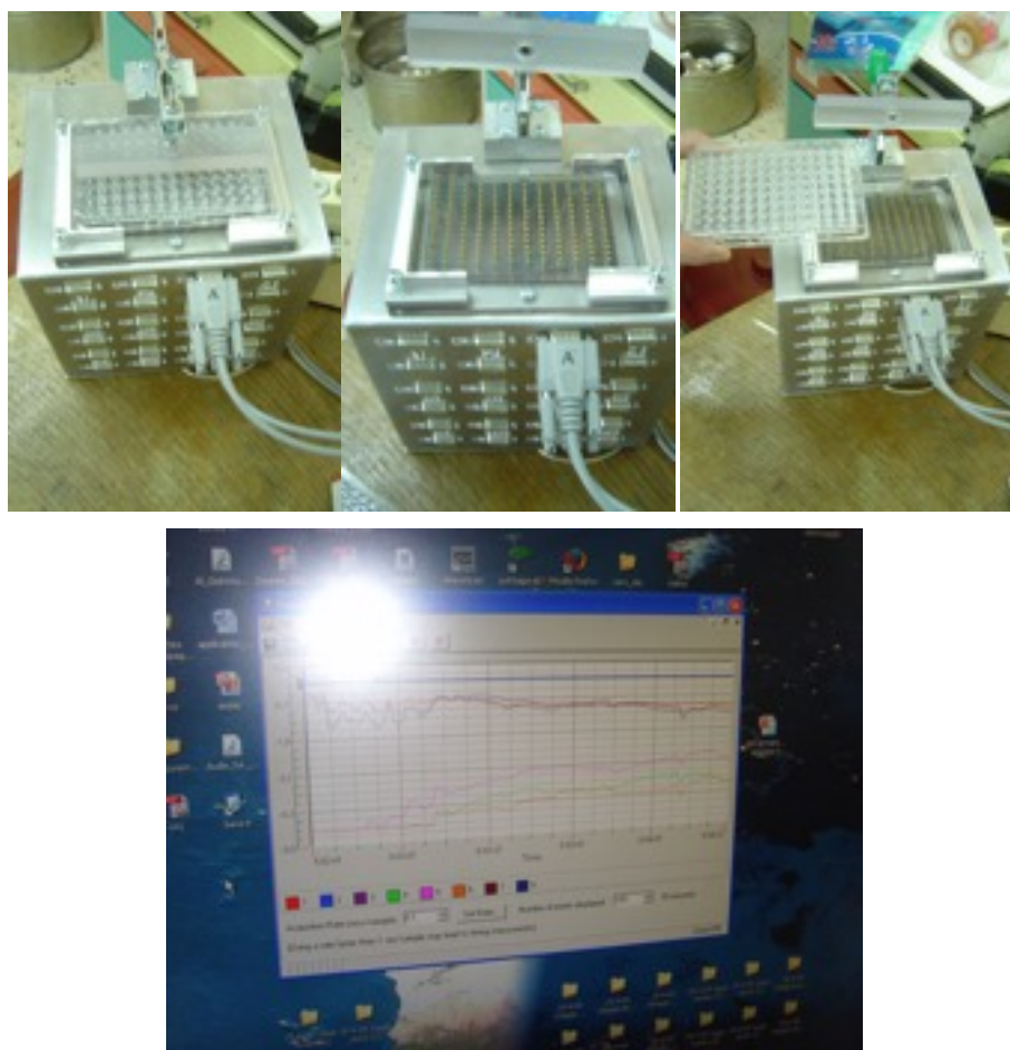
Σχήμα 2.4 Σύνδεση του βιοαισθητήρα BERA τύπου πλακιδίου ELISA με την ειδική βάση μέτρησης
