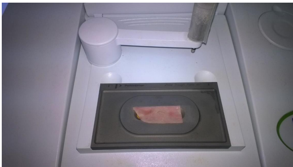
Εικόνα 7: Τοποθέτηση δείγματος πάνω στον κρύσταλλο του FTIR
