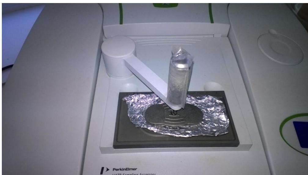
Εικόνα 11: Άσκηση πίεσης με το ειδικό έμβολο για βέλτιστη επαφή δείγματος-κρυστάλλου
