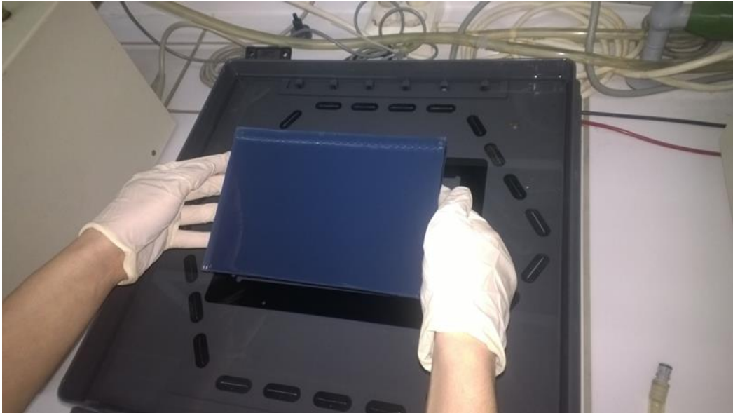
Εικόνα 24: Τοποθέτηση του gel στη συσκευή PFGE
