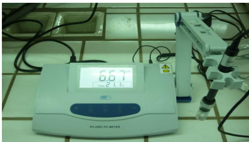
Εικόνα 9. Η μέθοδος του ηλεκτρικού προσδιορισμού του pH στηρίζεται στη μέτρηση της διαφοράς δυναμικού που αναπτύσσεται στη μεμβράνη του ηλεκτροδίου της υάλου και πραγματοποιείται με ειδικά όργανα που καλούνται πεχάμετρα .
