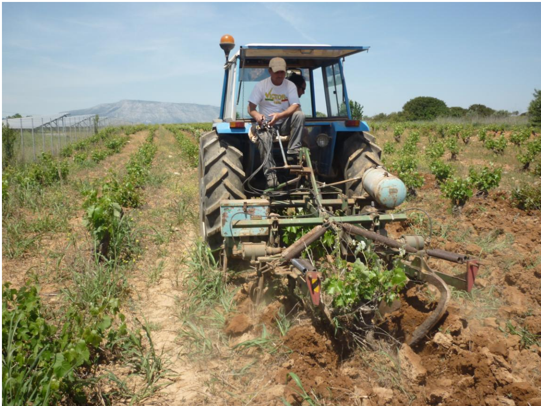
Εικόνα 27. Αμπελουργικός ελκυστήρας με αυτοσχέδιο παρελκόμενο μηχάνημα για την κατεργασία του εδάφους και ενσωμάτωση των ζιζανίων στον βιολογικό αμπελώνα.
