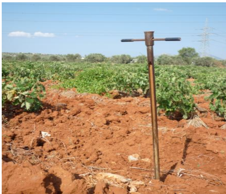
Εικόνα 7. Δειγματοληψία κατατομής εδάφους με δειγματολήπτη κλειστού τύπου.
