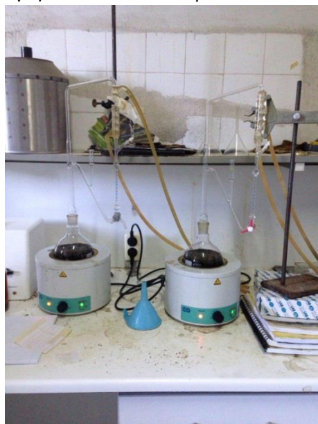
Εικόνα 15 : Συσκευές απόσταξης τύπου Clevenger με ξηρό φυτικό υλικό και απεσταγμένο νερό κατά τη διάρκεια του βρασμού
