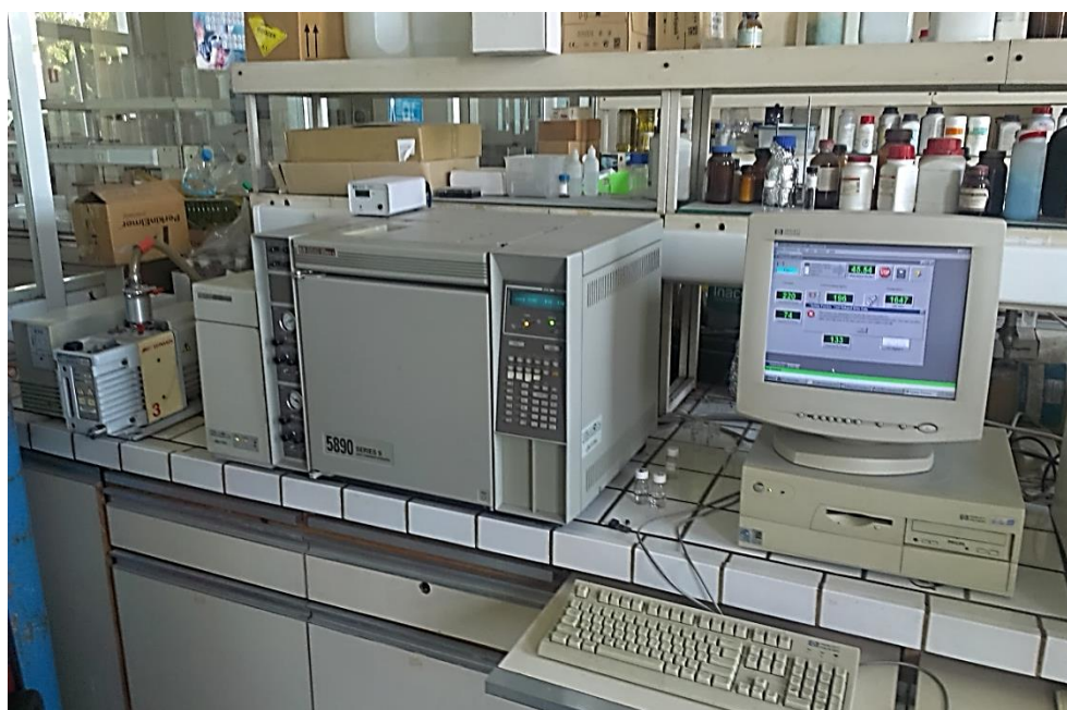
Εικόνα 17: Σύστημα GC/MS του Εργαστηρίου Γενικής Χημείας του Γ.Π.Α. που χρησιμοποιήθηκε για την ποιοτική και ποσοτική ανάλυση των αιθέριων ελαίων.
