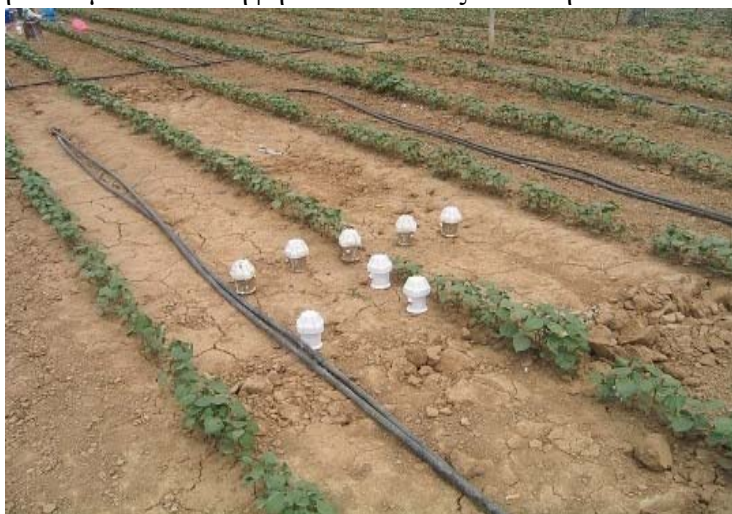
Εικ 2.6. Η διάταξη των σωλήνων για τη μέτρηση της εδαφικής υγρασίας
