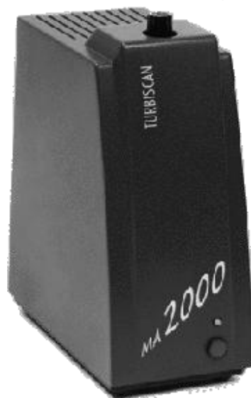
Εικόνα 24: Η συσκευή Turbiscan Classic MA 2000
