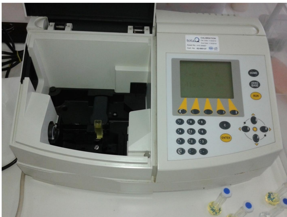
Εικ.32 : Μέτρηση απορρόφησης δειγμάτων με φασματοφωτόμετρο
