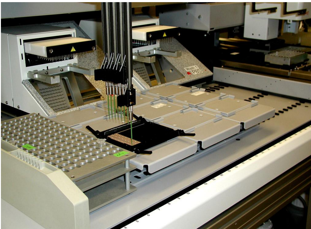
Σχήμα 6: Απεικόνιση ενός ρομποτικού διακριτού αναλυτή
