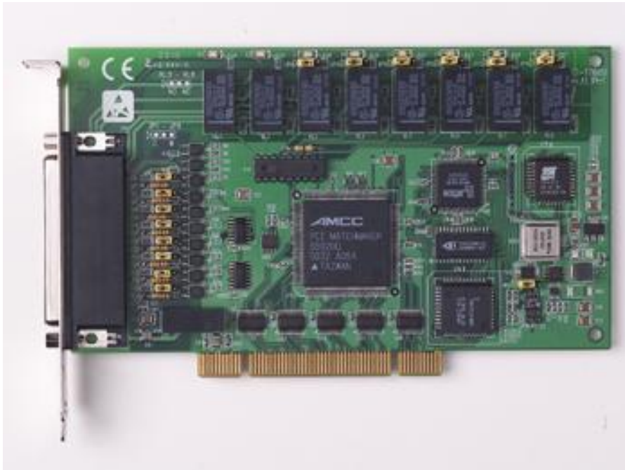
Σχήμα 57: Κάρτα ηλεκτρομηχανικών διακοπών PCI-1760U της εταιρείας Advantech, του αναλυτή FIA για εκτίμηση τοξικότητας.
