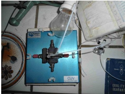
Όψη Γ: Τοποθέτηση της κυψελίδας ροής στη βάση για σταθεροποίηση
