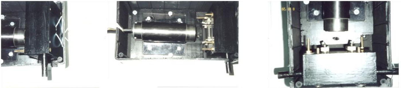
Στάδιο 2: Προσαρμογή του συστήματος θερμοστάτησης στον αυτοσχέδιο φορέα απέναντι από την λυχνία φωτοπολλαπλασιαστή.
