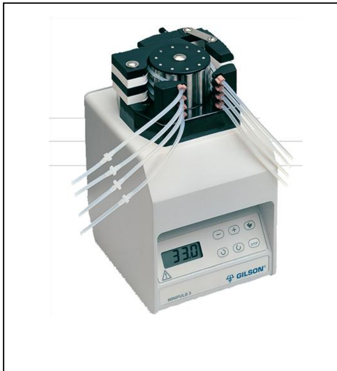
Σχήμα 62: Περισταλτική αντλία Gilson Minipuls 3 του αναλυτή FIA για προσδιορισμό τοξικότητας σε δείγματα νερού.
