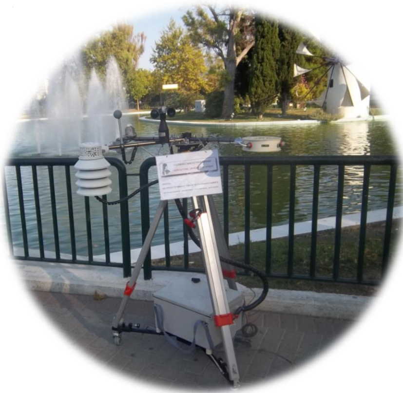
Εικόνα 3.9 Ο φορητός μικροκλιματικός σταθμός που χρησιμοποιήθηκε κατά τη διάρκεια των ερευνών πεδίου
