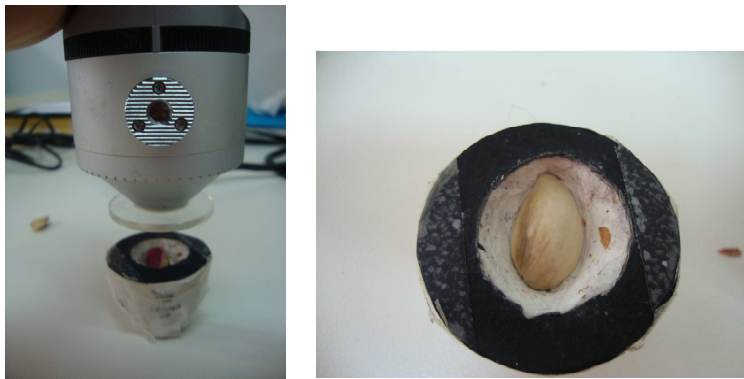
Σχήμα 76. Μέτρηση του χρώματος στο κέλυφος των φιστικιών με το χρωματόμετρο Minolta, CR-200. Ο καρπός τοποθετείται οριζόντια στον ειδικό υποδοχέα, ο οποίος εφαρμόζει στο στόμιο του οργάνου.
