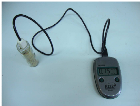
Σχήμα 78. Μέτρηση της θερμικής αγωγιμότητας σε αλεσμένη ψίχα κελυφωτού φιστικιού με το αγωγιμόμετρο.
