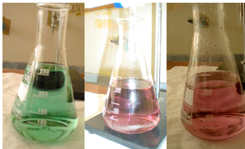
Σχήμα 45. Απεικόνιση της μεταβολής του χρώματος του (NH 4 ) 3 BO 3 κατά την τιτλοδότηση με HCl.
