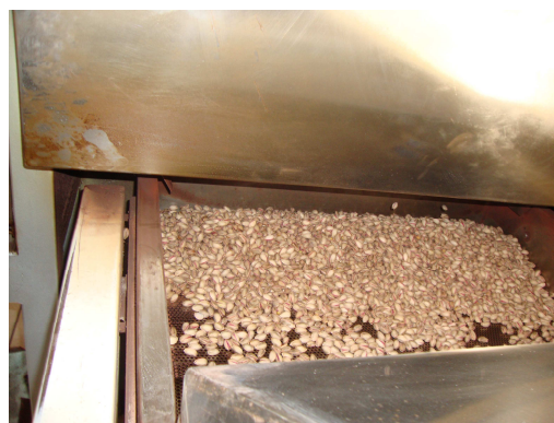
Σχήμα 5. Ανάμιξη φιστικιών με άλμη και κιτρικό οξύ και ψήσιμο στο φούρνο με κυλιόμενο ιμάντα. (Αγροτικός Συνεταιρισμός Φιστικοπαραγωγών Αίγινας).
