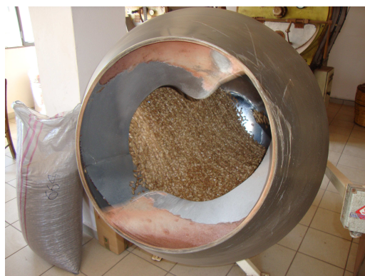
Σχήμα 5. Ανάμιξη φιστικιών με άλμη και κιτρικό οξύ και ψήσιμο στο φούρνο με κυλιόμενο ιμάντα. (Αγροτικός Συνεταιρισμός Φιστικοπαραγωγών Αίγινας).
