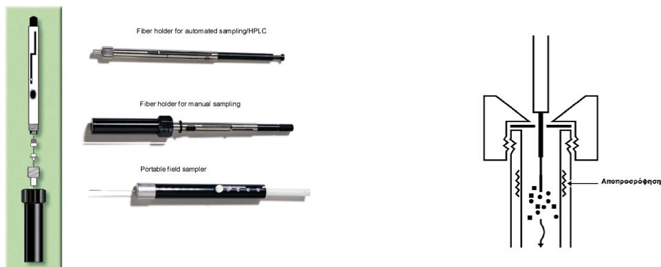
Σχήμα 18. Λειτουργία και μέρη της συσκευής της μεθόδου SPME.
