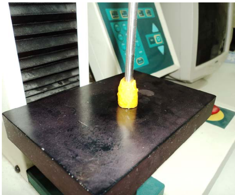
Εικόνα 57. Όργανο συμπίεσης του τεμαχίου ροδάκινου για τον προσδιορισμό της υφής
