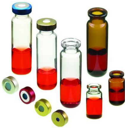
Εικόνα 22: Διάφορα φιαλίδια δειγματοληψίας και τα αντίστοιχα διαφράγματα (septa).
