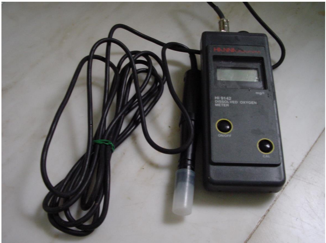
Εικόνα 6 Συσκευή μέτρησης διαλυμένου οξυγόνου της HANNA
