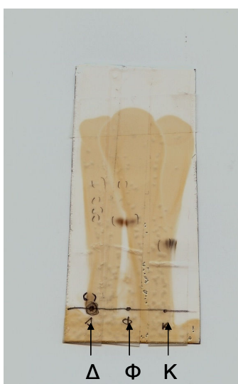
Σχήμα 2.9: TLC του E1 σε σύστημα ανάπτυξης A μετά από εμφάνιση με αιθανολικό διάλυμα FeCl 3 (Δ) καθώς και των προτύπων δειγμάτων φερουλικό οξύ (Φ) και καφεϊκό οξύ (Κ).
