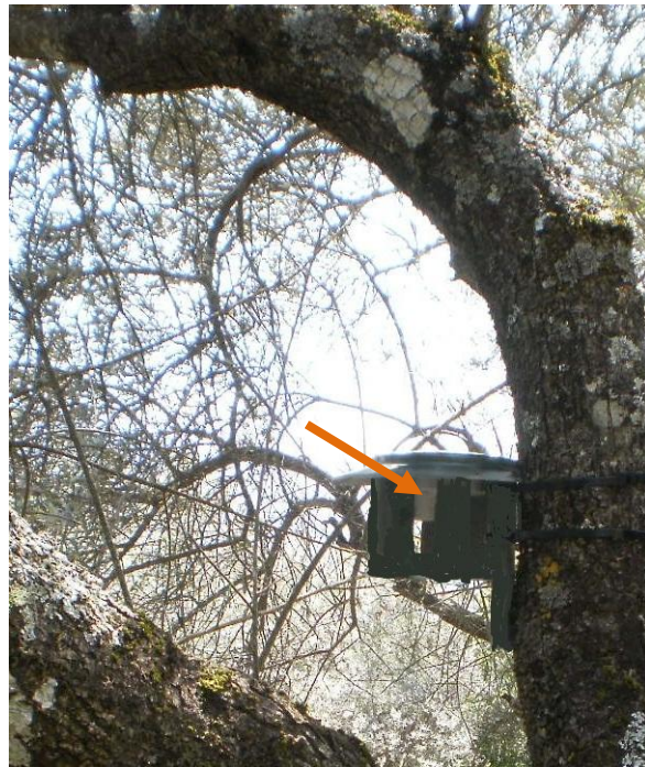
Εικ. 5: Καταγραφικό Hobo Pro U23-001 μέσα σε προστατευτικό κάλυμμα για την προστασία από τη βροχή και την ηλιακή ακτινοβολία (η θέση του με το βέλος)
