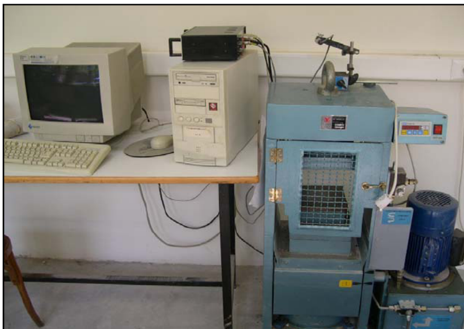
Εικόνα 5.10: Μηχανή εκτέλεσης δοκιμής ανεμπόδιστης θλίψης και Brazilian, Η/Υ καταγραφής και δίκαναλος ηλεκτρικός καταγραφέας.
