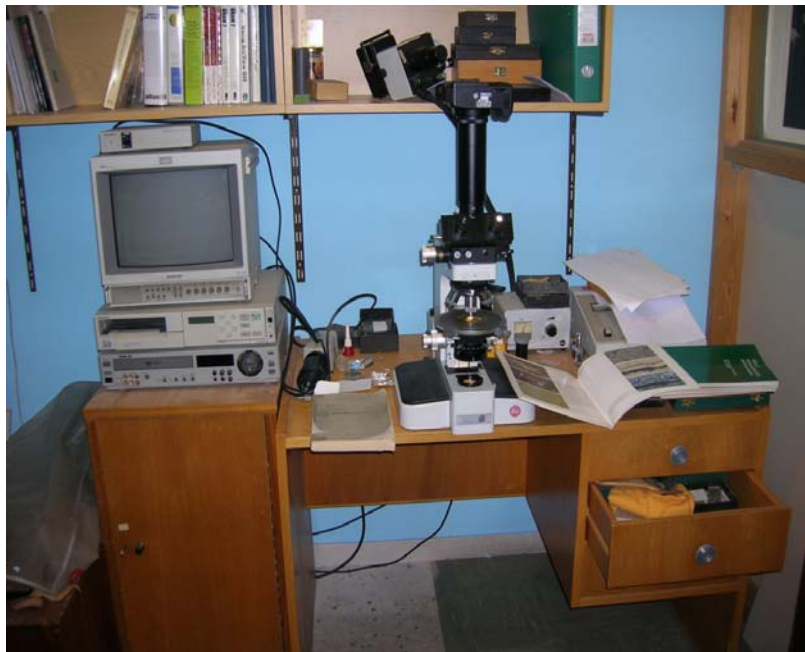
Εικόνα 7.1: Πολωτικό μικροσκόπιο με διερχόμενο φως τύπου Leitz-Orthoplan και ψηφιακή φωτογραφική μηχανή Canon.
