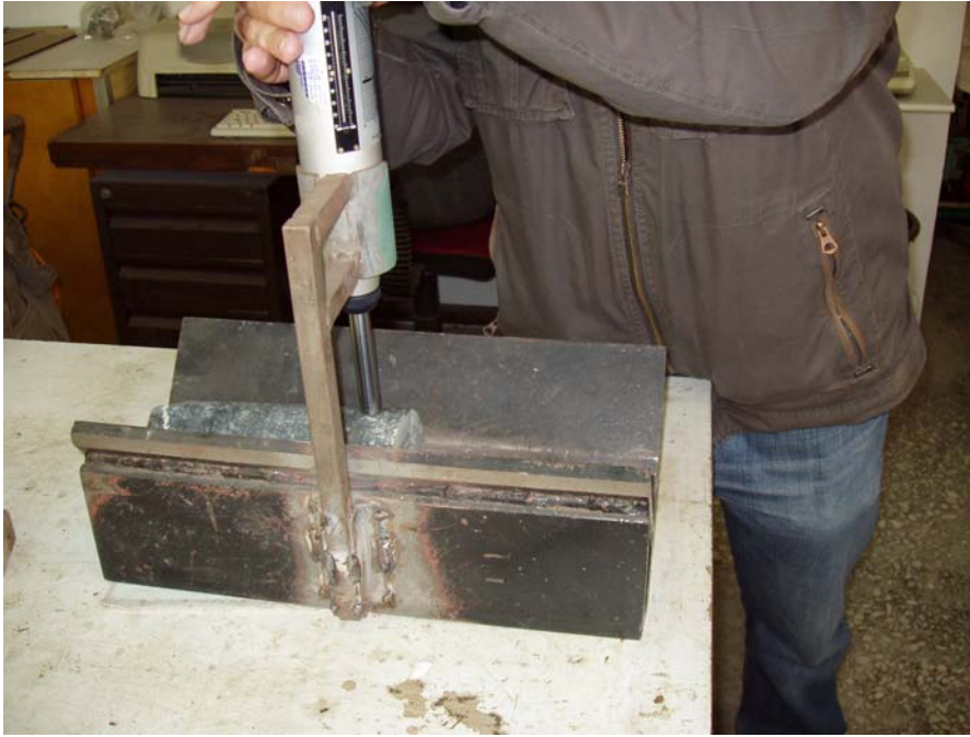
Εικόνα 5.8: Εκτέλεση δοκιμής σκληρότητας πετρώματος με το σφυρί Schmidt στο εργαστήριο.
