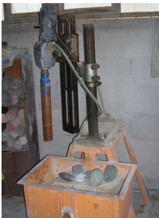
Εικόνα 5.3: Εργαστηριακός πυρηνολήπτης για τη διαμόρφωση κυλινδρικών δοκιμίων πετρώματος (ΚΕΔΕ).
