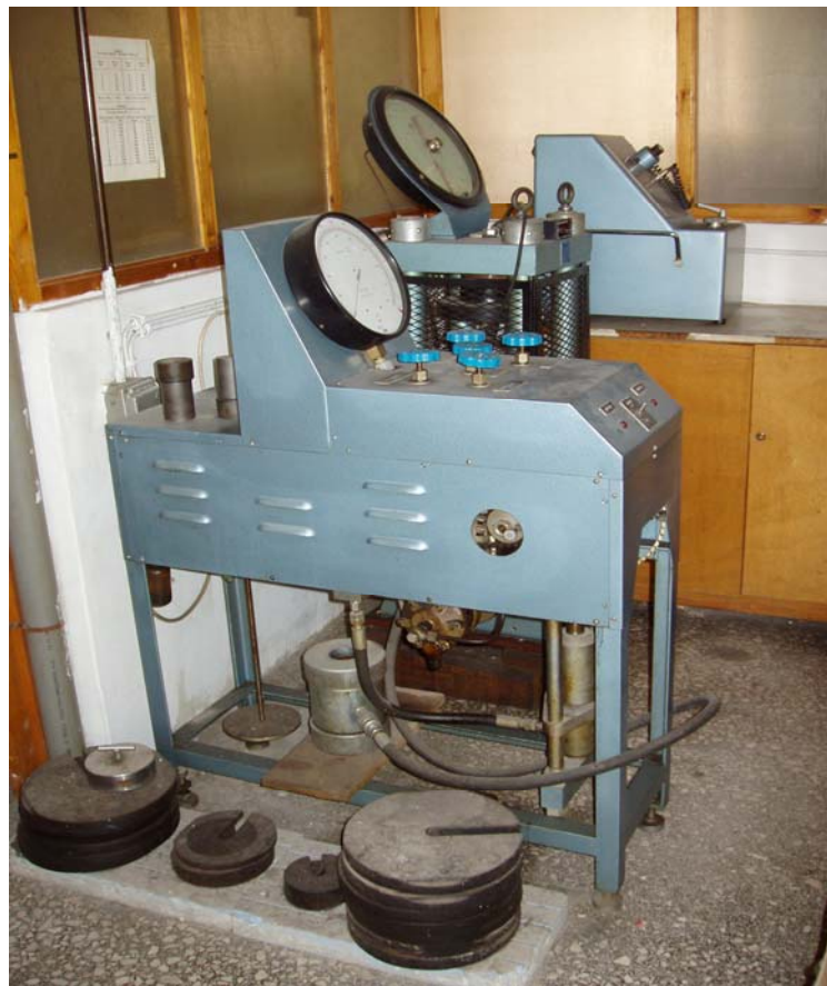
Εικόνα 5.11: Πλήρες σύστημα τριαξονικής δοκιμής σε βράχο που αποτελείται από συσκευή αξονικής φόρτισης (πρέσα), σύστημα πλευρικής πίεσης και τριαξονικό κελί υψηλών πιέσεων.
