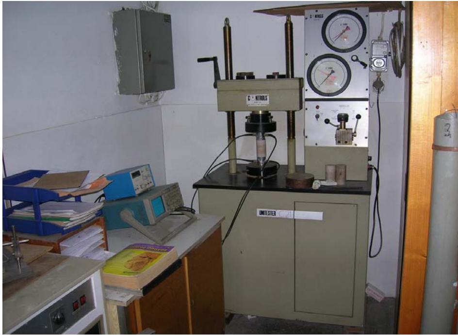
Εικόνα 5.7: Πλήρες σύστημα μέτρησης ταχύτητας υπερήχων σε βραχύδη δοκίμια.
