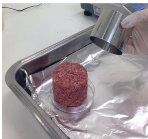
Εικόνες 2.2.1.1 & 2.2.1.2 Σχηματισμός δειγμάτων με την βοήθεια του τσέρκι (cerchi)
