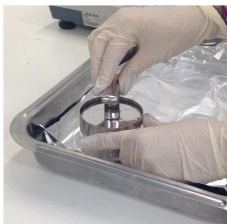
Εικόνες 2.2.1.1 & 2.2.1.2 Σχηματισμός δειγμάτων με την βοήθεια του τσέρκι (cerchi)
