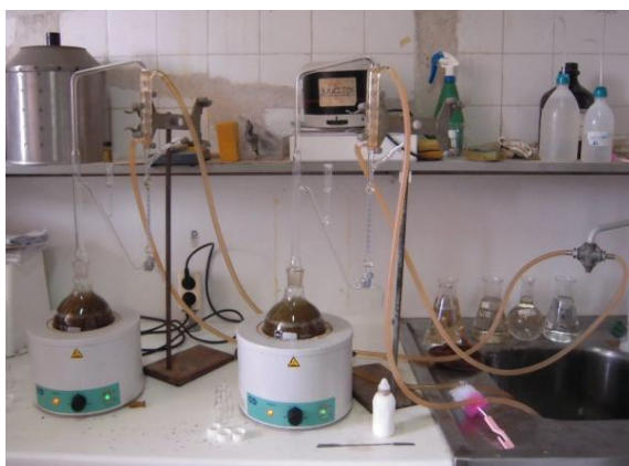
Εικόνα 16: Συσκευές απόσταξης με ξηρό φυτικό υλικό και απιονισμένο νερό κατά τη διάρκεια βρασμού.
