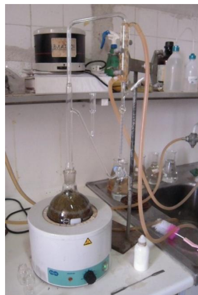
Εικόνα 7: Εργαστηριακή συσκευή απόσταξης, Clevenger, κατά τη διάρκεια διαχωρισμού του αιθερίου ελαίου (ελαφρύτερο) από το νερό.
