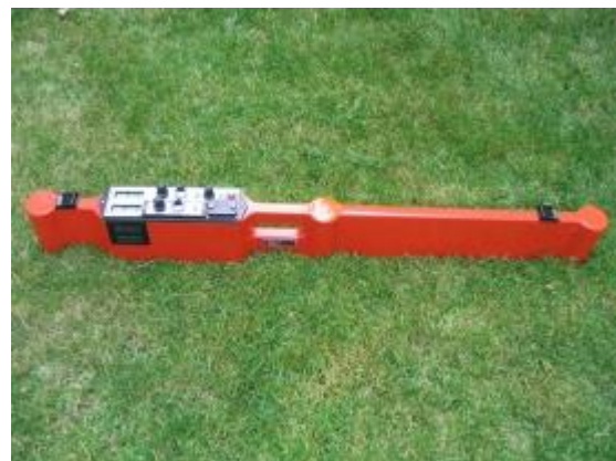
Εικόνα 6. Μέτρηση φαινομενικής ηλεκτρικής αγωγιμότητας (ECa) με χρήση του αισθητήρα EM38 RT, Geonics LTD
