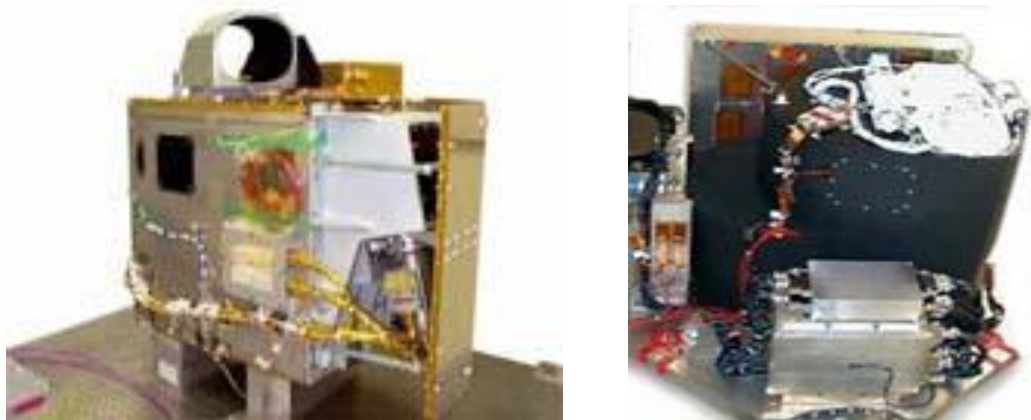
Εικόνα 3.4. Ο αισθητήρας Hyperion και ο αισθητήρας ALI αντίστοιχα (Κουκουβιάδης Δ., 2009)
