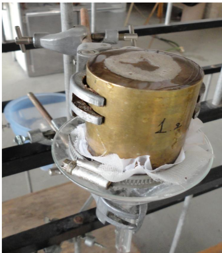
Εικόνα 3.8 Περατόμετρα σταθερού φορτίου, όπου (α) αδιατάρακτο εδαφικό μείγμα, (β) σήτα, (γ) χωνί, (δ) ογκομετρικός κύλινδρος, (ε) φιάλη Mariotte.
