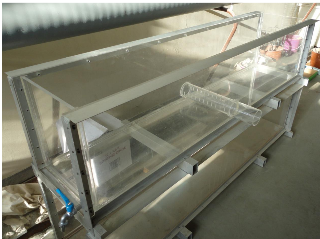
Εικόνα 2.1.β Δοχείο μετά τις ενισχύσεις, την στεγανοποίηση και την τοποθέτηση αποστραγγιστικού σωλήνα.
