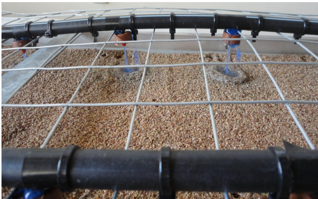
Εικόνα 4.3.α Χρωματισμός του νερού μέσω των σταλακτών.
