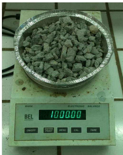
Εικόνα 3.2.β Κοσκίνισμα χαλικιών για ποσότητα δείγματος 1000g.
