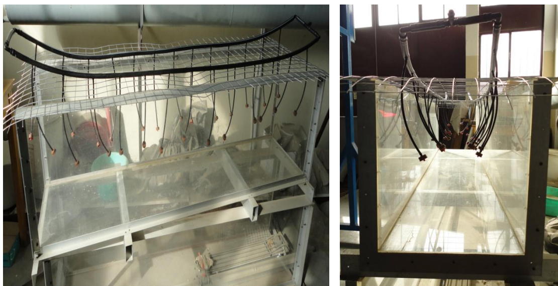
Εικόνα 2.2 Σύστημα Άρδευσης με 26 σταλάκτες σταθερής παροχής 12 Lt/h, οι οποίοι ισοκατανέμονται στο δοχείο.
