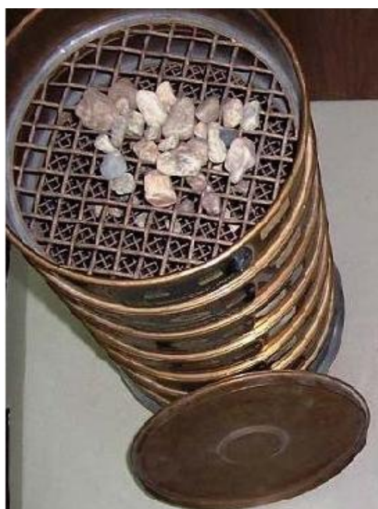
Εικόνα 3.3.α Σειρά πρότυπων κοσκίνων με κάλυμμα επάνω από το πρώτο κόσκινο και συλλέκτη κάτω από το τελευταίο.
