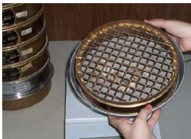
Εικόνα 3.7 Το άδειασμα του περιεχομένου των κοσκίων για ζύγιση πρέπει να αποφεύγεται.
