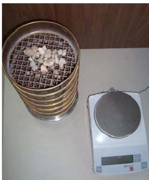
Εικόνα 3.6 Το προς ανάλυση υλικό τοποθετείται στο επάνω κόσκινο.
