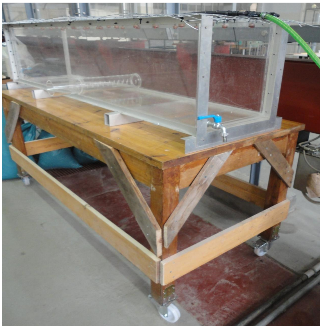
Εικόνα 2.4 Ανύψωση δοχείου και τοποθέτηση σε ενισχυμένη βάση.
