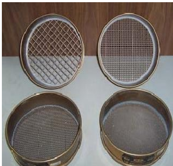
Εικόνα 3.4 Η ελάττωση των διαμέτρων των οπών των κοσκίνων έχει αποτέλεσμα να εγκλωβίζονται προοδευτικά περισσότεροι κόκκοι στους βρόγχους.
