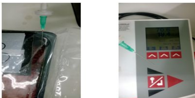
Εικόνα 4: Λήψη μέτρησης των αερίων του υπερκείμενου χώρου της συσκευασίας και το μηχανήμα μέτρησης αερίων Checkmate 9900 O 2 : CO 2 .
