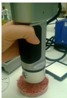
Εικόνα 5: Μέτρηση της μεταβολής του χρώματος με το φορητό χρωματόμετρο Minolta, Model CR-200.
