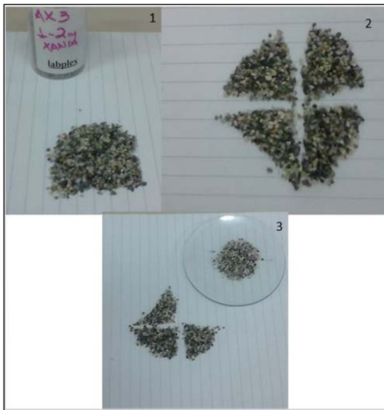
Εικόνα 1.4: Απεικόνιση των βημάτων που ακολουθήθηκαν για την κοκκομετρική ανάλυση του κάθε δείγματος
