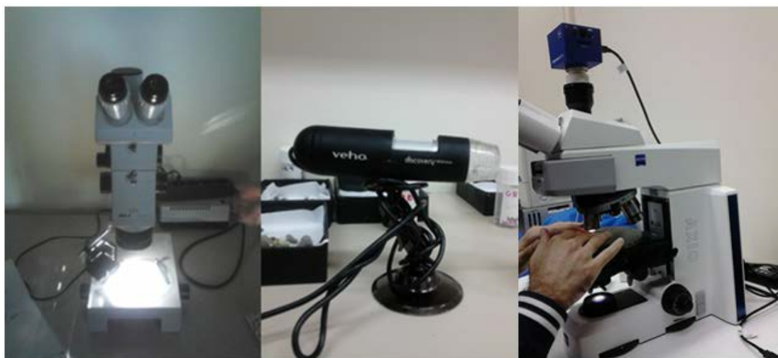
Εικόνα 1.5: Στερεοσκόπιο, φορητό μικροσκόπιο και ηλεκτρονικό μικροσκόπιο που χρησιμοποιήθηκαν για τον πετρολογικό και ορυκτολογικό προσδιορισμό των υλικών
