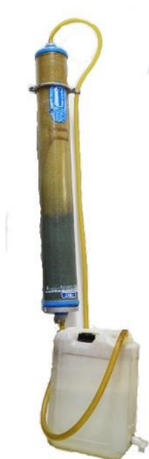
Εικόνα 39 Στήλη απιονισμού νερού
