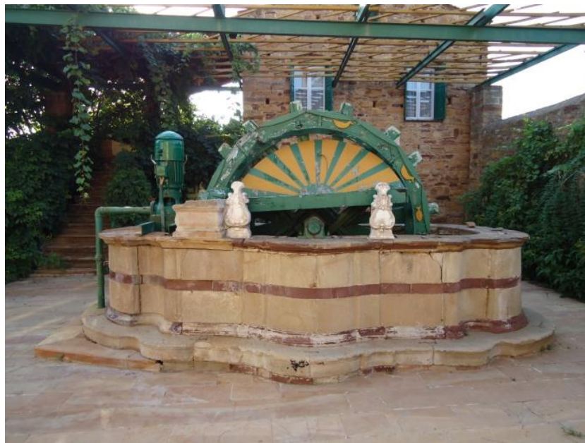
Εικ 143. Εξαιρετικό πλαίσιο (σεντούκι) στον μάγγανο του κτήματος Περλέα. Το σεντούκι είναι κατασκευασμένο από πέτρα σε μπέζ και κόκκινες αποχρώσεις. Ο μάγγανος είναι σιδερένιος ενώ τα σικλιά είναι τσίγκινα. (προσωπικό αρχείο)
