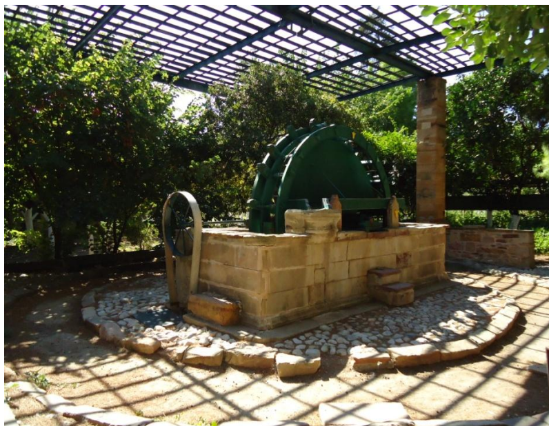
Εικ 206. Το μαγγανοπήγαδο, με το εξαιρετικό πέτρινο σεντούκι. Περιμετρικά του μάγγανου διακρίνεται ο μαγγανόγυρος όπου γύριζε το ζώο και έθεται τον μάγγανο σε λειτουργία. Πίσω από τον μάγγανο απλώνεται το περιβόλι με τα εσπεριδοειδή. (προσωπικό αρχείο)
