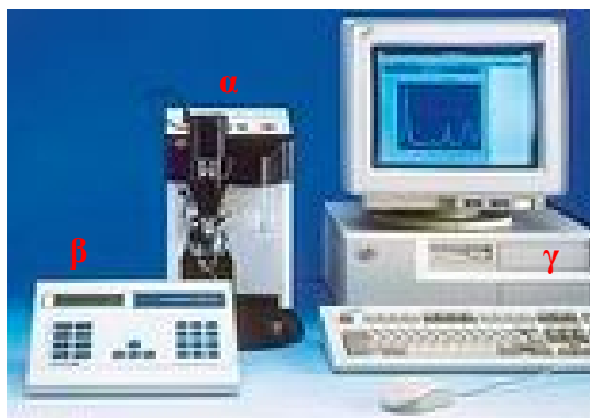
Εικόνα 1.22. Οργανολογία παλμικής πολαρογραφίας α) Η μονάδα περιλαμβάνει το σύστημα ηλεκτρονικού υπολογιστή και το πολαρογραφικό στοιχείο, β) ο αναλύτης μπορεί να χρησιμοποιηθεί στην κλασική ή παλμική πολαρογραφία, γ) τα αποτελέσματα καταγράφονται σε καταγραφέα χ-ψ.
