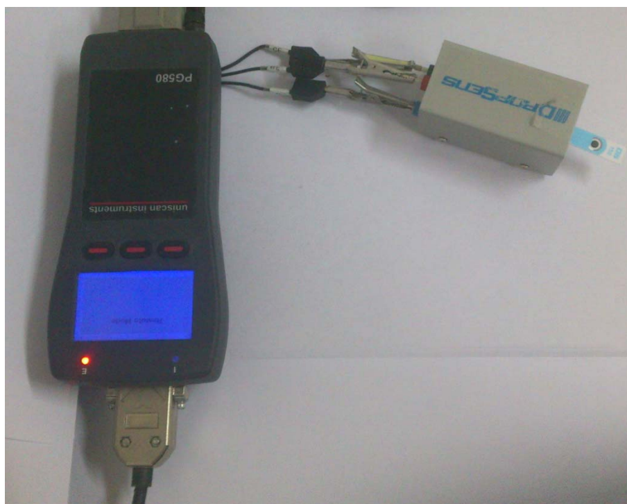
Εικόνα 2.5. Σύστημα ποτενσιοστάτη PG581 (Uniscan) συνδεδεμένο με μετασχηματιστή ηλεκτρικού σήματος που συνδέει τα εκτυπωμένα ηλεκτρόδια άνθρακα με τον ποτενσιοστάτη.
