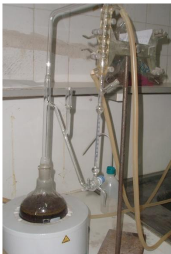
Εικόνα 10: Συσκευή Clevenger. Εξέλιξη υδροαπόσταξης στο φυτό O. hirtum στο Εργαστήριο Γεωργίας.
