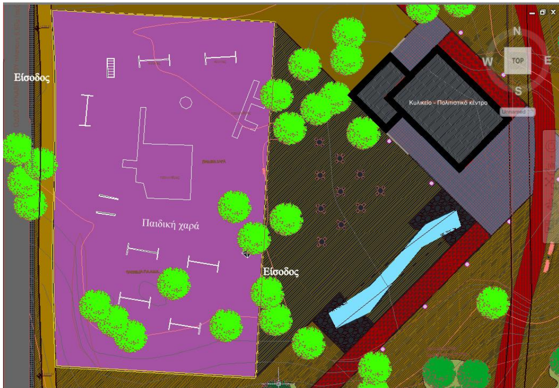
Εικόνα 7: Σχέδιο Γενικής διάταξης των οργάνων και του φυτικού υλικού της παιδικής χαράς (άνευ κλίμακας).
