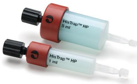
Εικόνα 2.8 : Στήλη συγγένειας HisTrap HP 5ml ( GE Healthcare Life Science )
