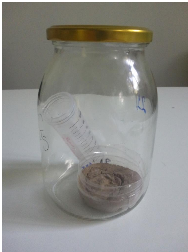
Σχήμα 5: Τα ειδικά βάζα που χρησιμοποιήθηκαν για τη μέτρηση της μικροβιακής δραστηριότητας. Μέσα στο βάζο περιέχεται δείγμα εδάφους, καθώς και falcon με κατάλληλη ποσότητα NaOH (παγίδα).
