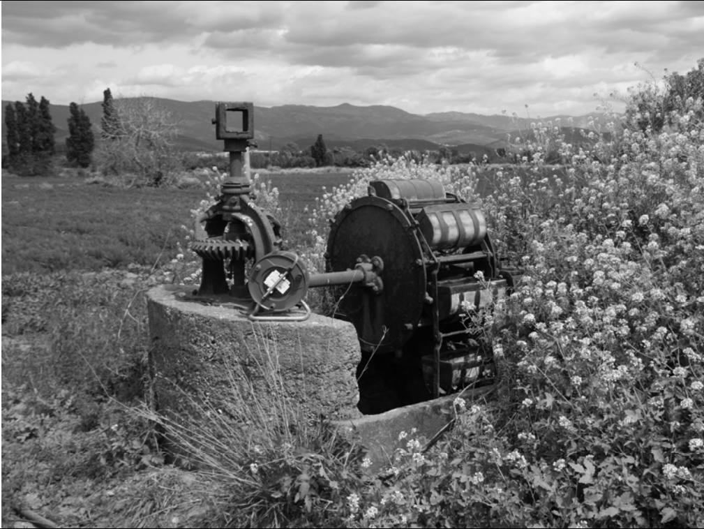
Παλιό πηγάδι με σύστημα κυλιόμενων δοχείων
