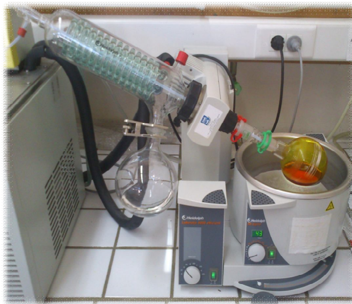
Εικόνα 2.2 Συμπύκνωση διαλύτη σε περιστροφικό συμπυκνωτή κενού
