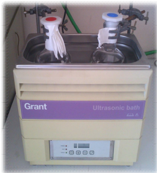
Εικόνα 2.1 Εκχύλιση υποβοηθούμενη από υπερήχους
