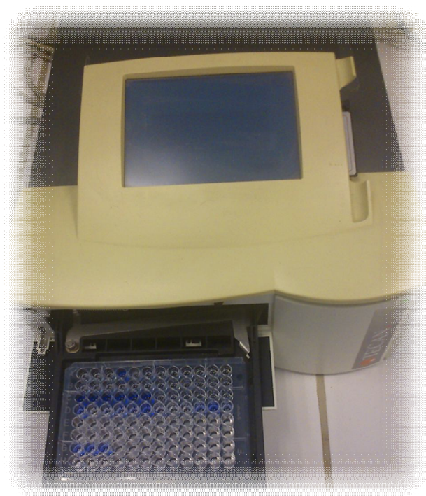
Εικόνα 2.7 Μέτρηση της απορρόφησης στα 600 nm με το φωτόμετρο
