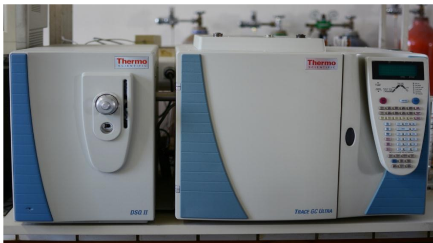
Εικόνα 18: Το σύστημα αέριας χρωματογραφίας-φασματομετρίας μαζών (GC-MS) που χρησιμοποιήθηκε
