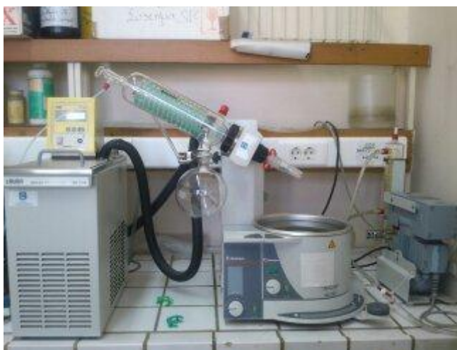
Εικόνα 17: Περιστροφικός συμπυκνωτής, Rotary evaporator
