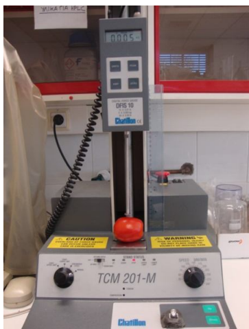
Εικόνα 5.6. Επιτραπέζιο πενετρόμετρο Chatillon DFIS 10 προσαρμοσμένο στη βάση Chatillon TCM 201.
