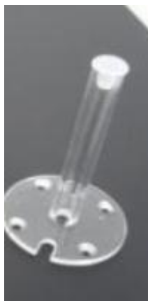
Εικόνα 2.25. Ειδική βάση τοποθέτησης δείγματος μηριαίου οστού διαμέτρου 6mm, ενώ για τοποθέτηση δείγματος σπονδυλικής στήλης χρησιμοποιούμε βάσεις διαμέτρου 10mm.
