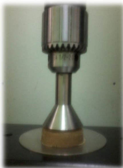
Εικόνα 6. Μέτρηση του φαινομενικού Ιξώδους ζύμης μπισκότων με το μηχάνημα Instron.
