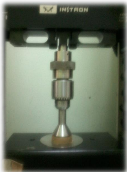
Εικόνα 6. Μέτρηση του φαινομενικού Ιξώδους ζύμης μπισκότων με το μηχάνημα Instron.
