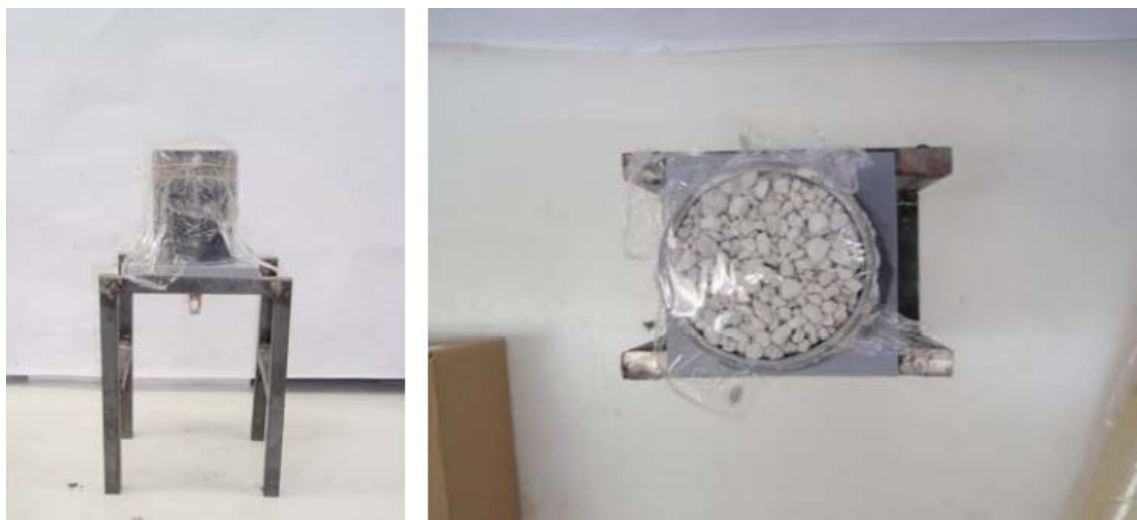
Εικόνα 2.6: Απεικόνιση των μικρολυσιμέτρων αεροστεγώς κλεισμένα για την μέτρηση του pH και του EC σε διαδοχικά χρονικά διαστήματα.
