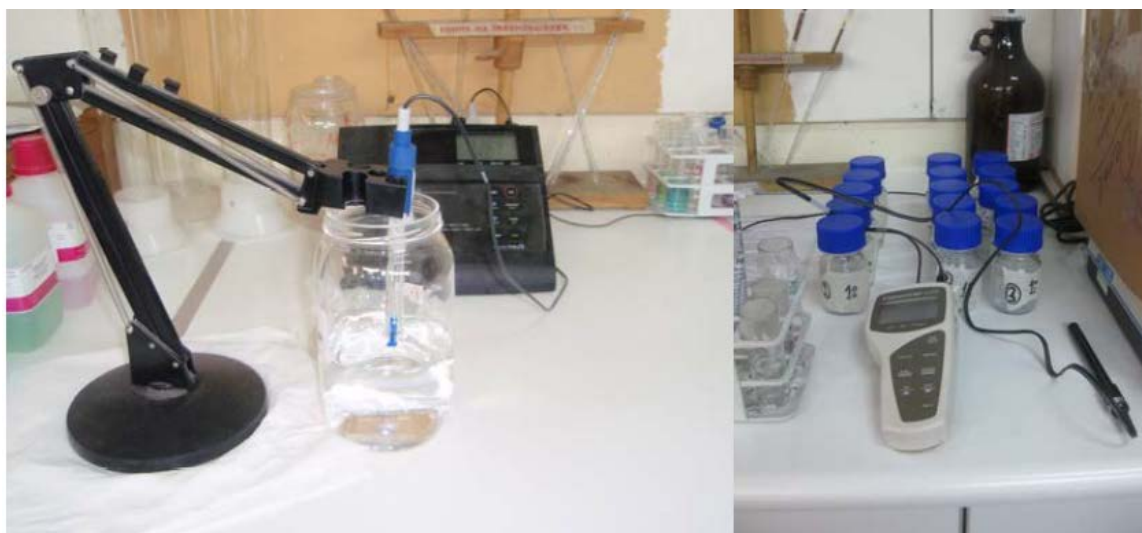
Εικόνα 2.3: Εργαστηριακός εξοπλισμός για τον προσδιορισμό των pH και EC των προϊόντων έκπλυσης.
