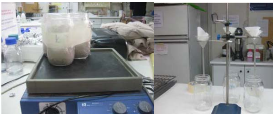
Εικόνα 2.4: Απεικόνιση του μηχανήματος ανάδευσης και η διήθηση για τον προσδιορισμό του pH και του EC.
