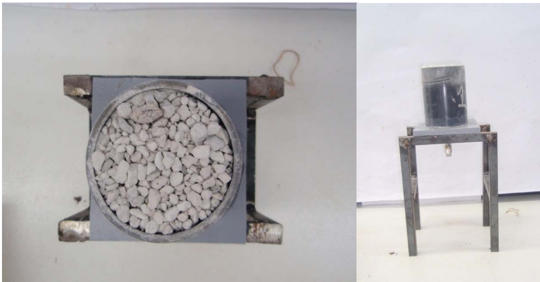
Εικόνα 2.2: Προσδιορισμός του όγκου πορώδους της ελαφρόπετρας 0-8 mm σε κάθε μικρολυσίμετρο.
