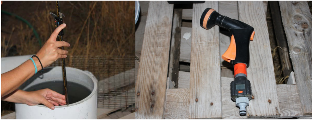
Εικόνα 2.7: Απεικόνιση εξατμισόμετρου και ψηφιακού μετρητή ροής.
