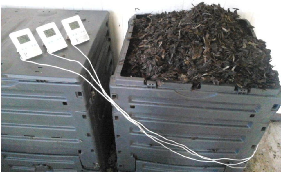
Εικόνα 10: Κάδος κομπόστ με τοποθέτηση θερμομέτρου σε τρία σημεία από την πειραματική διαδικασία.
