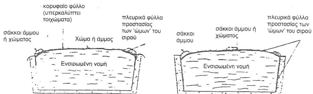
Εικόνα 6: Τρόποι πλήρωσης και σφράγισης της νομής σε σιρούς.
