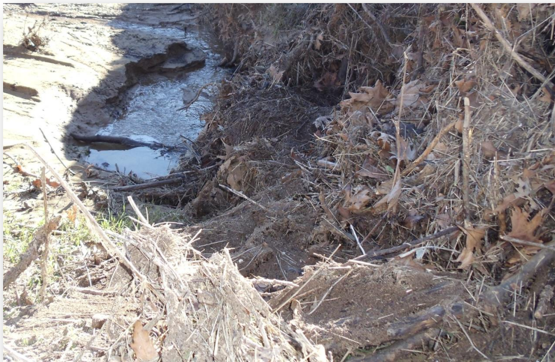
Σχήμα 20: Το υλικό που συγκρατεί το φράγμα είναι αρκετά ετερογενές και αποτελείται από λεπτόκοκκο έως χονδρόκοκκο υλικό, κροκάλες, οργανικό υλικό, φύλλα, κλαδιά κ.α, εξαιτίας των έντονων πλημμυρικών φαινομένων. Από το υλικό αυτό συλλέχθηκε δείγμα για εργαστηριακή ανάλυση.
