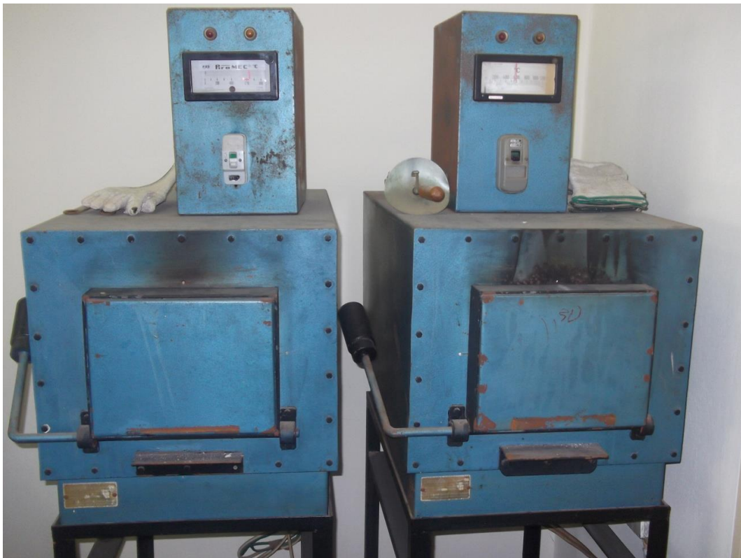
Εικόνα 4. Φούρνοι αποτέφρωσης που χρησιμοποιήθηκαν για την αποτέφρωση των δειγμάτων φυτικών ιστών
