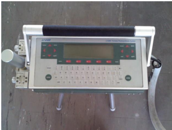
Εικόνα 5. Κεντρική κονσόλα χειρισμού της συσκευής φωτοσύνθεσης LI-6400 (α) και του θαλάμου φύλλου (β)
