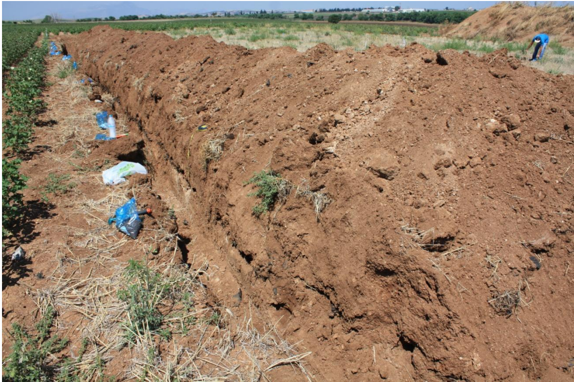
Εικόνα 15: Συλλογή δειγμάτων εδάφους κάτω από τη στρώση των ελαστικών σε όρυγμα βάθους 2 m και επιφανειακά στην καλλιέργεια σιταριού.
