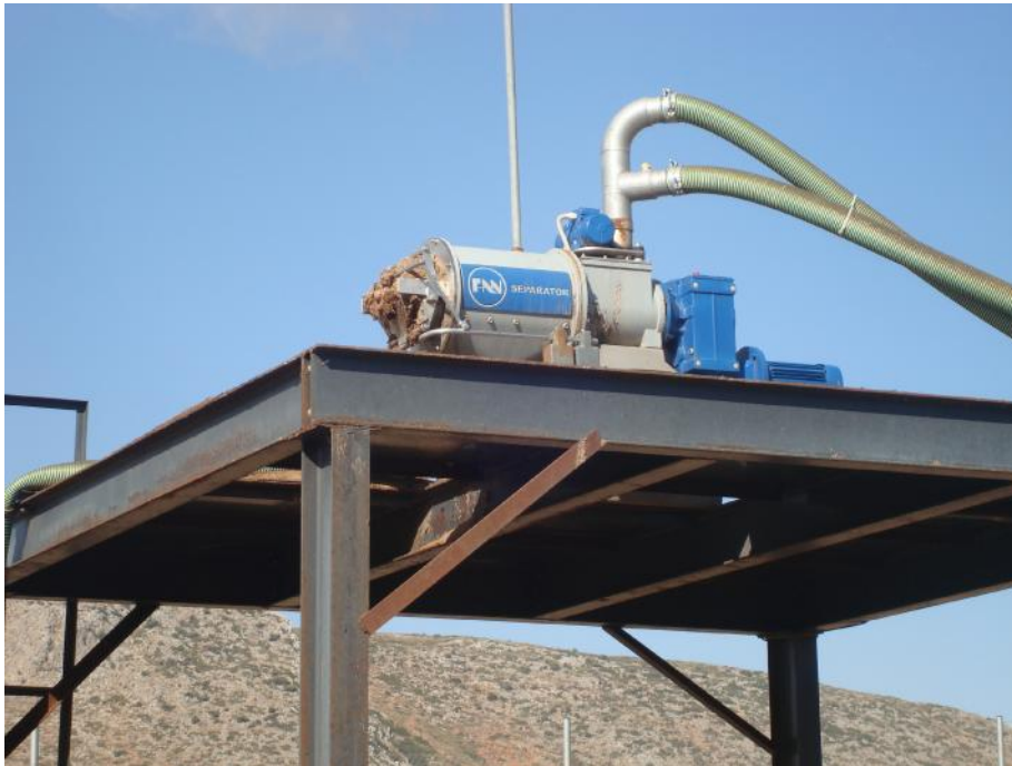
Εικόνα 6. Κοχλίας συμπίεσης (σύστημα Fan separator)
