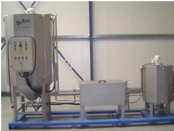
Εικόνα 4 Παραγωγή βιοντίζελ σε παρτίδες (Batch process)
