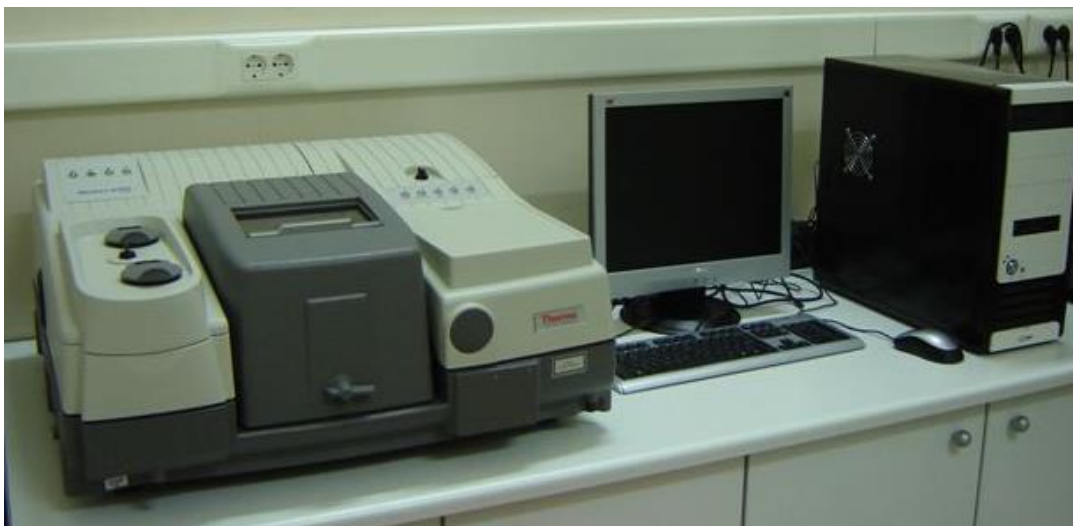
Εικόνα 9. Φασματόμετρο υπερύθρου Thermo Nicolet 7600, που χρησιμοποιήθηκε για την επεξεργασία των λυοφιλωμένων δειγμάτων εκφύτων του xM. florentina .
