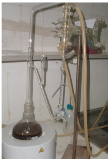
Εικόνα 2.7.1. Συσκευή Clevenger. Εξέλιξη υδροαπόσταξης στο φυτό O. hirtum στο Εργαστήριο Γεωργίας
