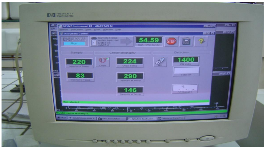
Εικόνα 2.10.2. Η οθόνη του υπολογιστή δείχνει το χρόνο 54.59 λεπτά που απομένουν να ολοκληρωθεί η ανάλυση, (συνολικά απαιτούνται 63 λεπτά). Ακόμα, φαίνεται η θερμοκρασία εισαγωγέα, που είναι 220^{\circ}\text{C} και η θερμοκρασία ανιχνευτή στους 290^{\circ}\text{C} .
