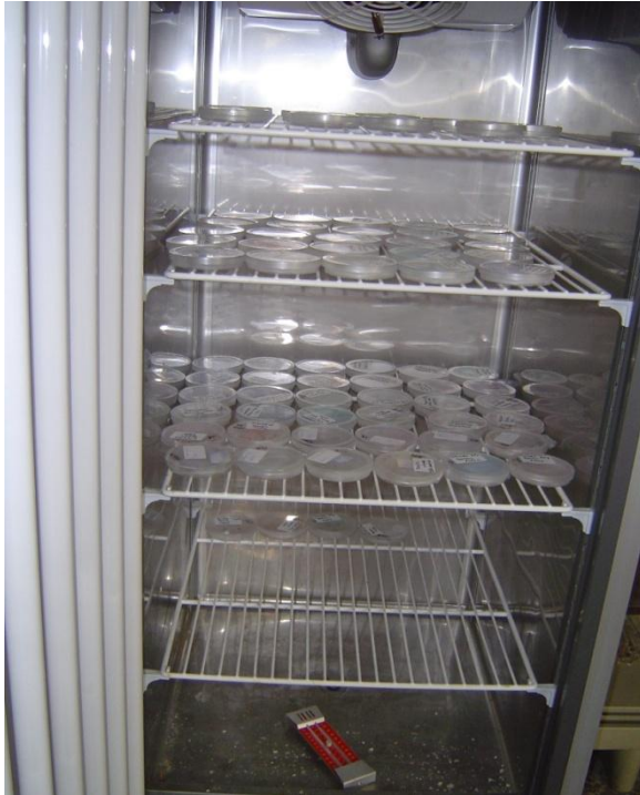
Εικόνα 2.9.1. Θάλαμος ελεγχόμενων συνθηκών όπου τα τρυβλία είναι τοποθετημένα (20 0 C, σκοτάδι)
