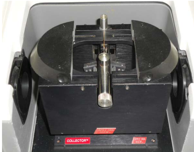
Εικόνα 4.7.2 : Υποδοχέας δείγματος που φέρει καγίδιο με φυτικό υλικό.
