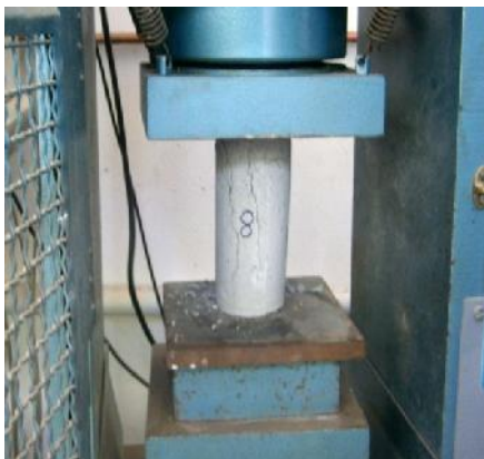
(Εικ.217) Θλιπτική κατάσταση του δοκιμίου Κατακόρυφες ρωγμές θραύσεως για τον ζεόλιθο
