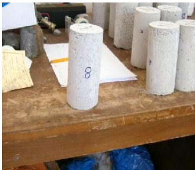
(Εικ.216) Επιλογή δοκιμίου Ζεόλιθου Τοποθέτηση στην συσκευή θλίψεως
