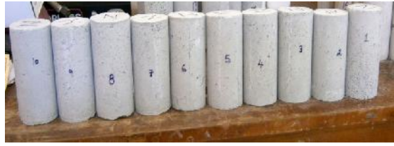
(Εικ. 215) Μέτρηση (l και d) των δοκιμίων Προετοιμασία και αρίθμηση των Ζεόλιθων
