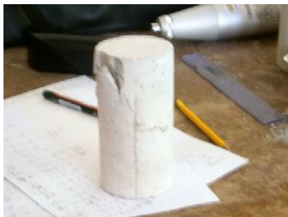
(Εικ.218) Διατμητικές ρωγμές θραύσεως του δοκιμίου Ασβεστόλιθου
