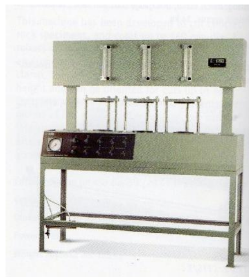
(Εικ. 76) : Παροχή και συλλέκτης νερού, Συσκευή υδατοπερατότητας τελευταίου τύπου)
