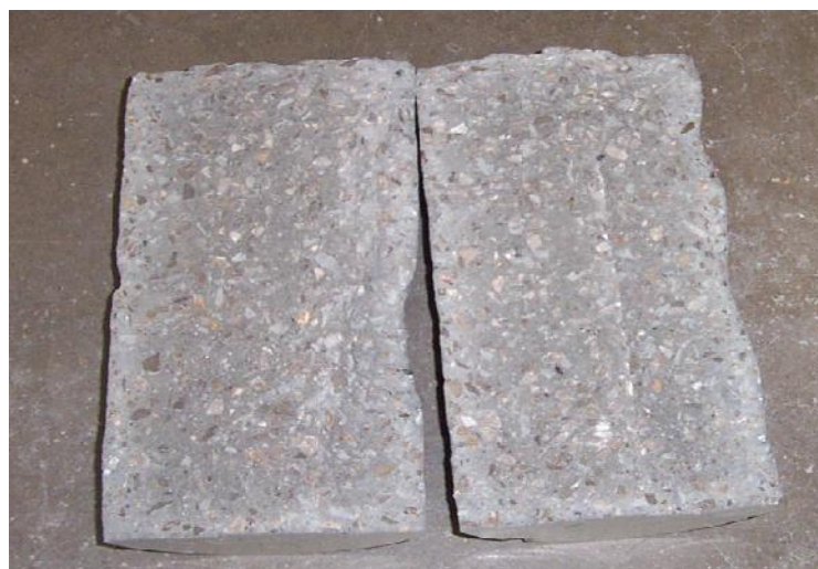
(Εικ.95) Αποτέλεσμα της διάρρηξης σε κάτοψη
