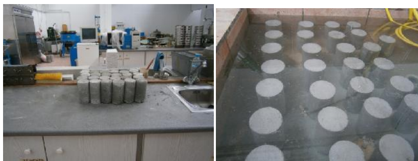
(Εικ.214): Ξεκαλούπωμα δοκιμίων και συντήρηση με την μέθοδο του εμποτισμού
