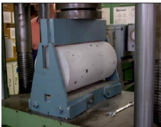
(Εικ.94 ) δοκιμή διάρρηξης (γνωστή και ως “Brazilian Test”)
