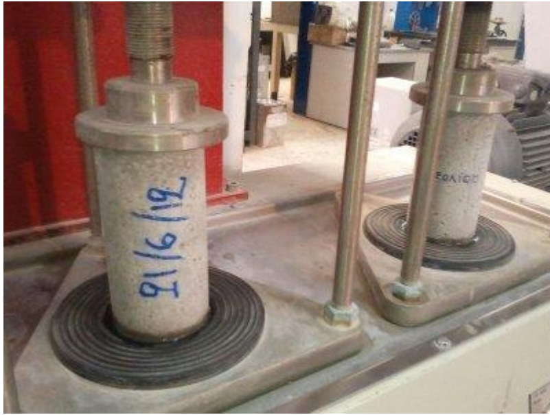
(Εικ.223): Δοκιμή υδατοπερατότητας των Ζεόλιθων
