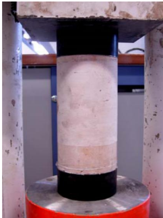
(Εικ.80) Τοποθέτηση κυλινδρικού δοκιμίου με χρήση άνω και κάτω παρεμβλήματα
