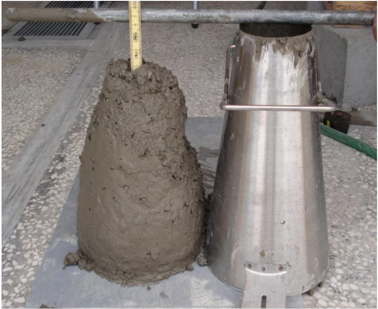
(Εικόνα 6): Δοκιμή κάθισης με τον κώνο του Abrams
