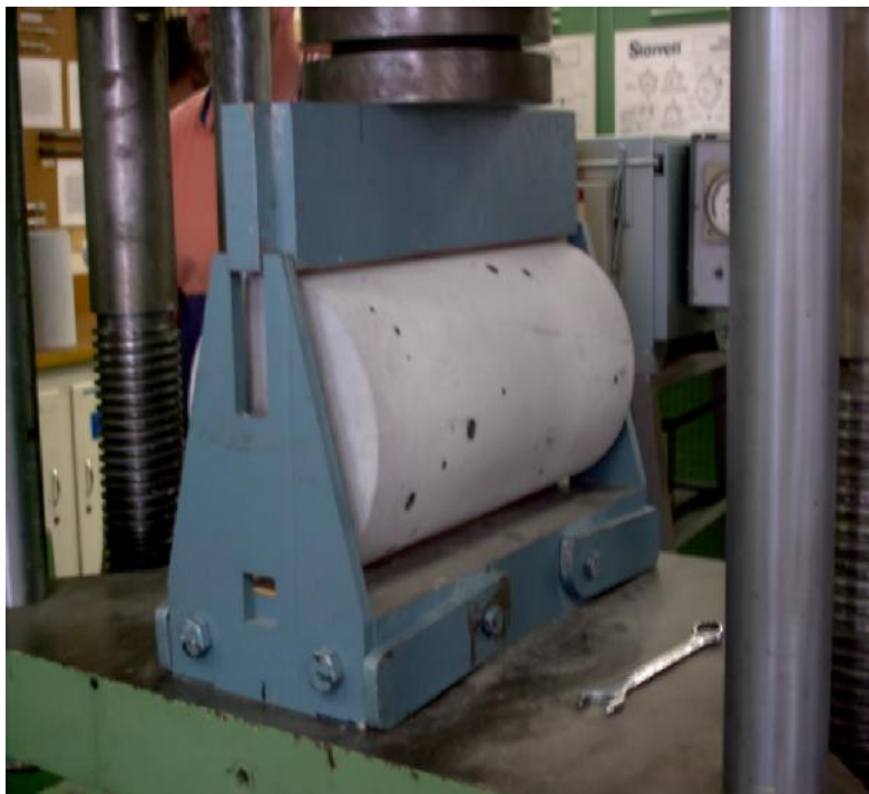
(Εικ.194): Συσκευή διάρρηξης κυλινδρικών δοκιμίων [Splitting tensile test device for cylindrical specimens]
