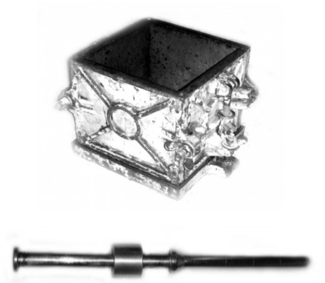
(Εικόνα 16): Μετρητής Humm και δοχείο για τον έλεγχο της συνεκτικότητας
