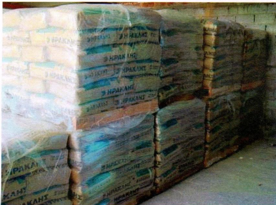
(Εικ. 55): Αποθηκευμένο τσιμέντο σε χάρτινες συσκευασίες καλυμμένες με προστατευτικό νάilon και στηρίζονται πάνω σε ξύλινες βάσης (παλέτες) , 10 cm από το πάτωμα μετ'όχι καθαριότητας
