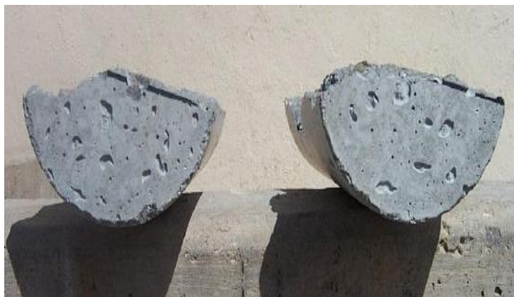
(Εικ.96) Αποτέλεσμα της διάρρηξης σε πλάγια τομή
