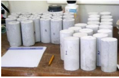
(Εικ. 215) Μέτρηση (l και d) των δοκιμίων Προετοιμασία και αρίθμηση των Ζεόλιθων
