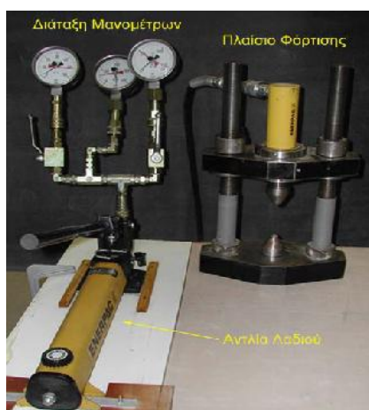
(Εικ.98) : Συσκευές σημειακής φόρτισης διαφόρων τύπων (α), (β) και (γ))
