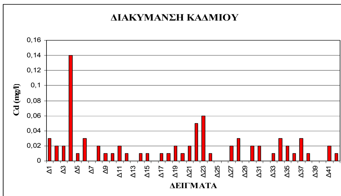
Σχήμα 7.35: Η διακύμανση του καδμίου (Cd) στα υπόγεια νερά του κεντρικού τμήματος της Ν. Λέρου. Με κόκκινο χρώμα απεικονίζονται τα υπόγεια νερά, που ξεπερνούν το όριο των 0,005 mg/l.
